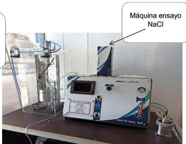
Estación de verificación de mascarillas modelo SAFTE NaCl 0.2.
